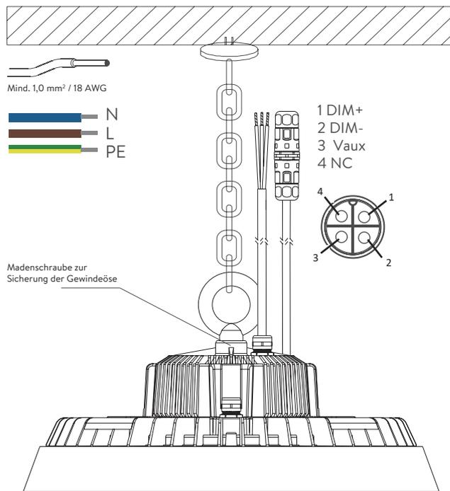
Die so vorbereitete Leuchte kann anschließend mit der Gewindeöse an der Abhängung befestigt werden. Das verwendete Montagematerial ist auf die Anforderungen der Leuchte und den örtlichen Gegebenheiten abzustimmen.
