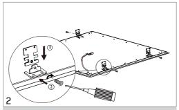
Snap-In Kit mit den beigefügten Schrauben befestigen.
