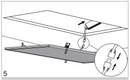
Treiber sekundärseitig anschließen und Doppelschenkelfeder an einer Seite hochdrücken.
