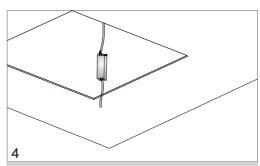
Netztrennung und primärseitiger Anschluss des Treibers.
