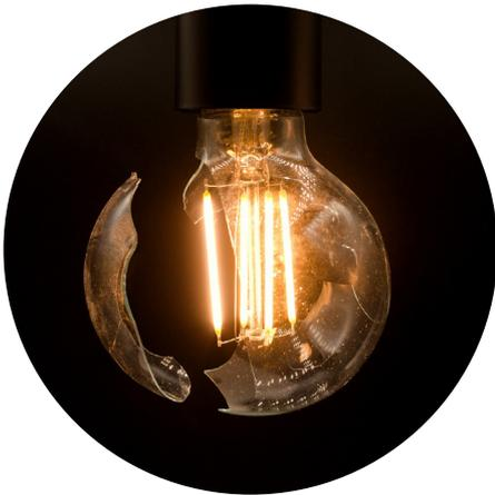
Die Widerstandsfähigkeit eines Leuchtengehäuses gegenüber Stößen misst sich am IK-Stoßfestigkeitsgrad. Das Maß verdeutlicht, wie schlagfest und bruchfest bzw. bruchsicher ein Gehäuse ist und wie viel Schlagenergie in Joule das Gehäuse aushalten kann, ohne zu brechen.
